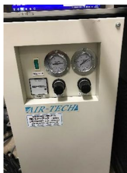
図 1. 乾燥圧縮空気を供給するのに必要なユニット
