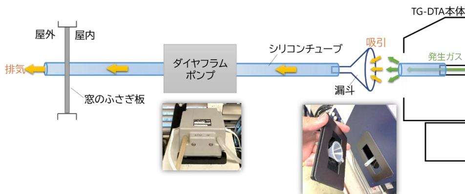
図2 TG-DTAのガス排出経路
